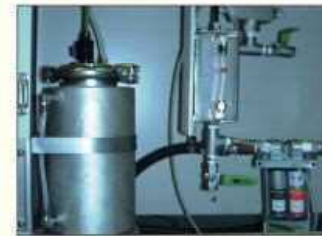
■2L金属容器 (フラックス切れアラーム機能付き) 2L flux tank with flux short alarm
